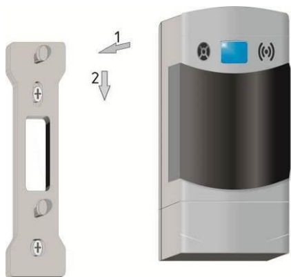
Рисунок 5 – Установка сигнализатора на монтажную панель
